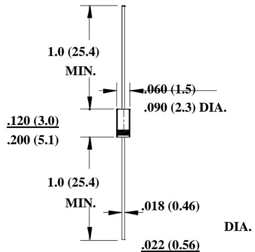
外形尺寸: 英寸 (毫米)
