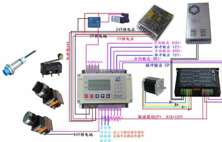
电源说明：本控制器工作供电为 5v 电源。（可提供步进电机工作的脉冲输出和方向输出）
