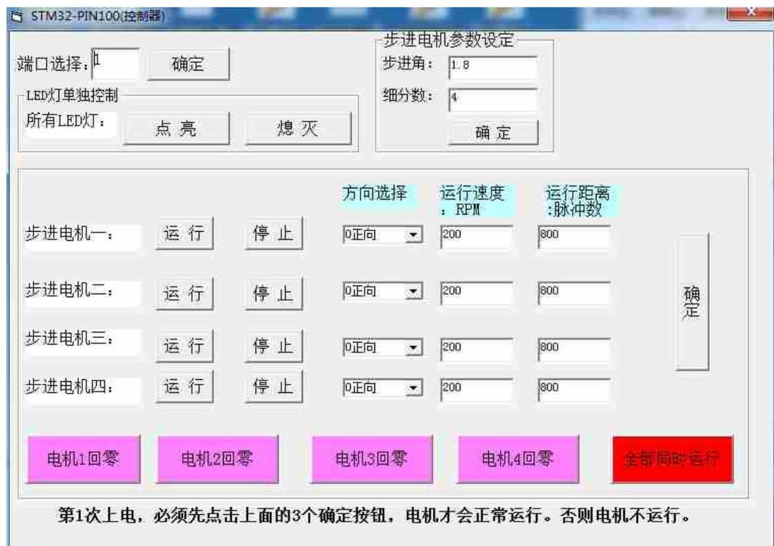
注意：在使用上位机软件进行控制的时候，STM32 学习板第 1 次上电后，图中的几个确定按钮都必须点击 1 次，（作用是把电机运行的参数发送下去），电机才能够正常控制。
