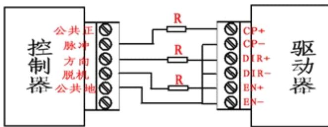
注：EN 端可不接，EN 有效时电机转子处于自由状态（脱机状态），这时可以手动转动电机转轴，做适合您的调节。手动调节完成后，再将 EN 设为无效状态，以继续自动控制
