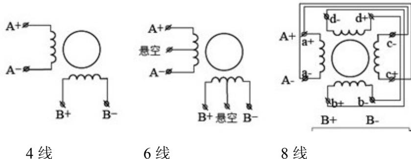
四线直接接入；六线不接中间抽头，将两头的接起来即可（中间抽头可根据阻值确定）；八线可采用并联或串联接法，并联为大电流接法。
