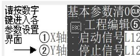
在1号界面即“控制界面”，按下键进入该界面。在该界面下可以选择进入XY轴的参数设置界面；也可以选择进入工程操作(编程)。以及设定外部输入信号口作启动信号和停止信号。
