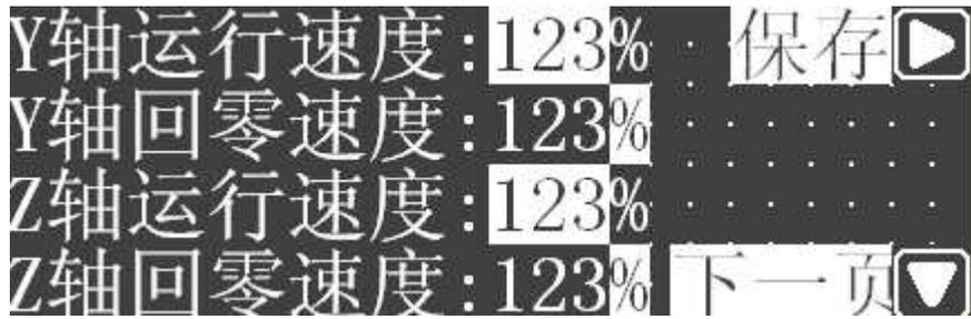
运行速度：就是电机正常加工的速度；
