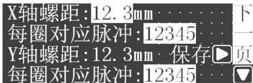
设定各电机对应轴的螺距，和每圈对应的脉冲数据。
