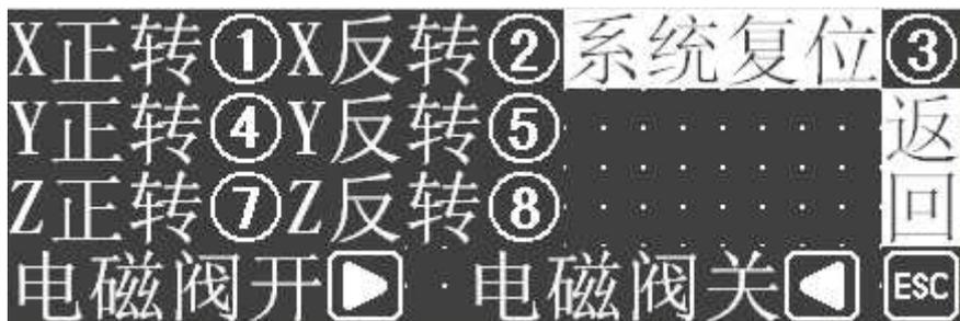
在本界面可以，通过相对应的按键，进行电机正、反方向的试机和调试。同时本系统也可以通过外面的外接开关进行测试，详细在本说明书首页的图上标出了。
