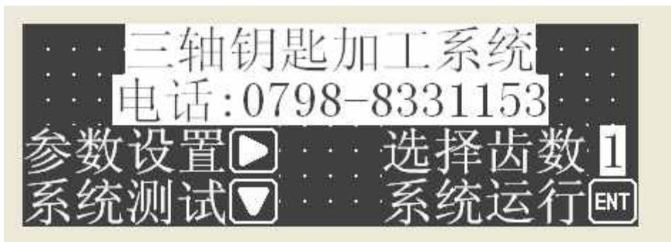
分别对应按键进入：参数设置；电机运行测试；系统运行界面。
