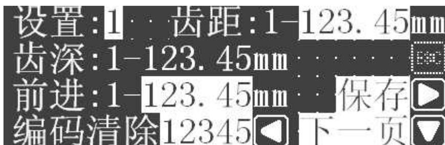
本界面可以设置：5 齿分别对应的 X 运行的齿距；Y 轴运行的齿深；Z 轴运行的前进距离。在界面上按“SET”键，可以进入各参数
